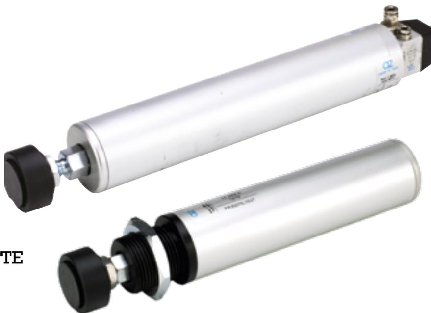
Nello specifico la versione diametro 35 mm è realizzata anche con valvola di blocco unidirezionale direttamente integrata nella testata, la quale può essere posizionata ruotandola di 360° e disporre ingresso aria nella posizione più idonea. La valvola direttamente integrata permette al cilindro in fase di bloccaggio pezzo e mancanza d'aria di mantenere in posizione lo stelo e quindi il
