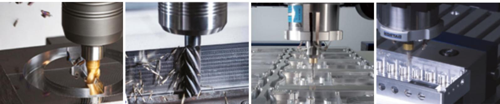
Ogni particolare viene creato attraverso la fresatura meccanica a controllo numerico e successivamente rifinito manualmente. Grazie alle
