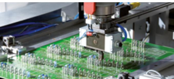
Assemblaggio componenti PTH e saldatura ad onda
