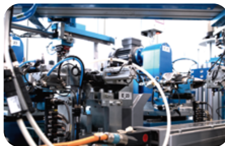
Applicazione su macchina automatica con cilindri sensorizzati
