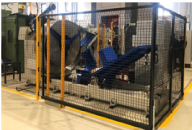
**Linea compatta da 600 mm di larghezza con coil portata 6 t installata presso SIT di Rovigo. La particolarità della linea è quella di avere un ribaltatore integrato nel sistema direttamente nella culla di carico, progettato e costruito interamente da Servopresse per risolvere il problema del cliente che non è dotato di un carro ponte in grado di ribaltare i coil pallettizzati che riceve.**
