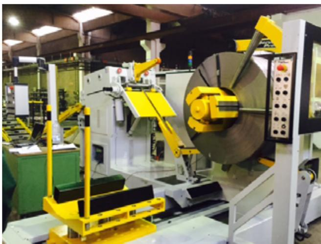
**Dotare la vostra linea di alimentazione con l'opzione dell'apertura della testa della raddrizzatrice, per consentire un facile accesso ai rulli per le operazioni di pulizia. Questo è particolarmente utile per le stampatrici che possono formare sia materiale scaglioso laminati a caldo, sia acciaio o alluminio laminato a freddo sulla stessa macchina.**
