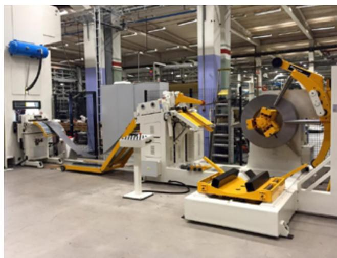
Alcune teste di raddrizzatrici-alimentatrici compatte includono una ruota di misurazione ad anello chiuso che fornisce il feedback all'unità di controllo per indicare i movimenti effettivi del materiale e non soltanto la rotazione dei rulli. Ciò è utile, per esempio, nel caso in cui un blocchetto venisse raccolto nello stampo e i rulli di alimentazione scivolassero sul materiale.
