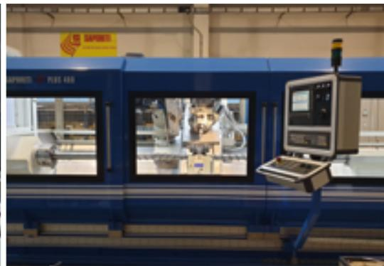
e viti hanno profili sempre più complicati e con queste macchine possono essere realizzate viti e biviti co-rotanti e contro rotanti, con filetti complessi, miscelatori, camme e passi variabili (per lavorare plastica, gomma, alimenti, da trasporto, per pompe e compressori). Esistono filettatrici per frese frontali, a disco e whirling.
