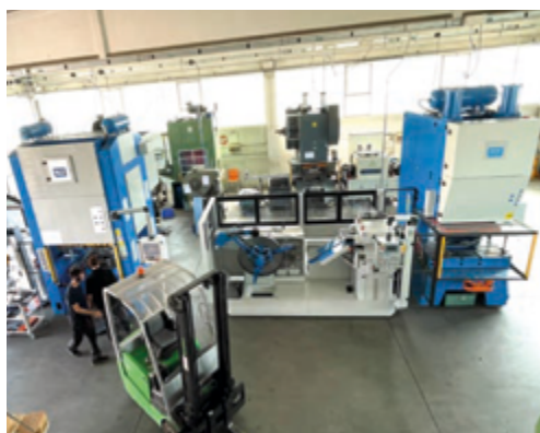
Attrezzatura UMF ha acquistato due linee di raddrizzatura/alimentazione SMTCP 400 AE T4 installate nel reparto di trancia
