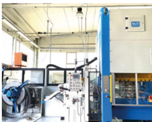
L'aspo svolgitore ha una portata di 4.000 kg ed è dimensionato per coil con una larghezza massima di 400 mm
