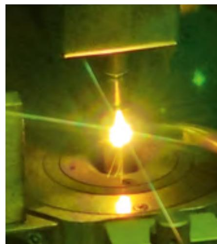
L'azienda **M.C.A.** è in grado di realizzare prodotti finiti propri o su progetto dei clienti, quali cilindri, elettropiloti, elettrovalvole ed altro. Dal 2001 si è specializzata nell'assemblaggio e collaudo di elettrovalvole e nella saldatura laser dei gruppi canotto in acciaio per elettrovalvole.
