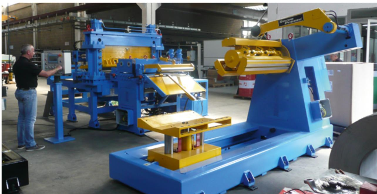
Costruita su un unico basamento che include svolgitoro traslante, sella di caricamento e raddrizzatrice alimentatrice, ha il vantaggio di non richiedere fondazioni o allineamenti riducendo così le fasi di installazione. La versione presentata è un 15.000 kg. di portata 1300 mm di larghezza massima e in grado di lavorare spessori da 0,6 a 6 mm.
