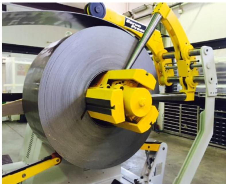
portata max di 20 tonnellate, uno spessore min/max. di 0,2 a 20 mm. e ad una larghezza min/max. da 200 a 2000 mm. Come:
