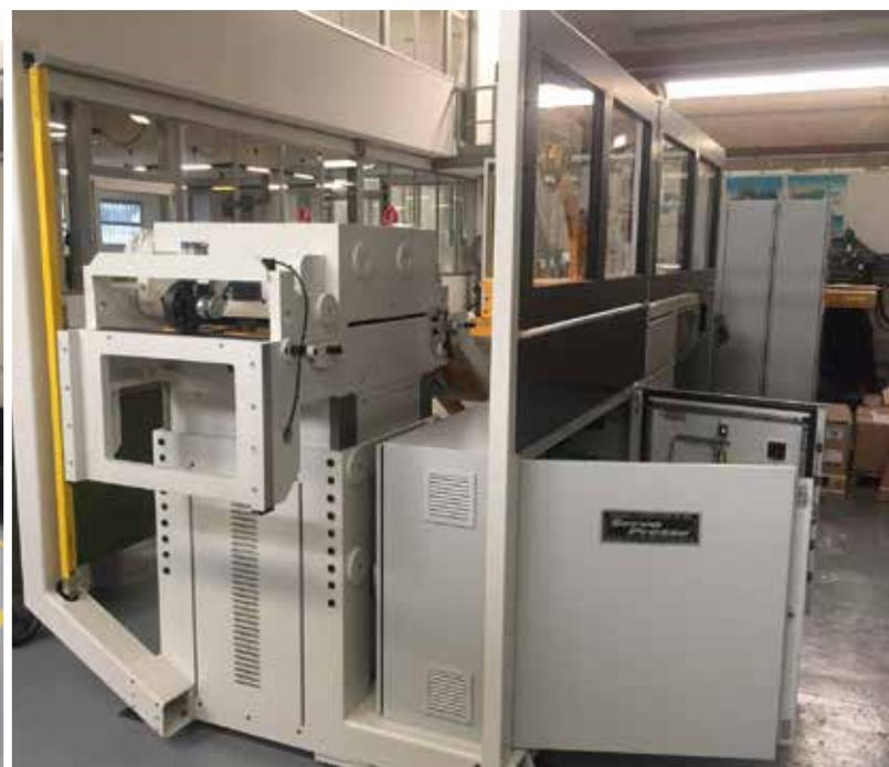
Pur molto compatta, la linea è completa in ogni suo aspetto essendo composta da svolgitore e da una raddrizzatrice/alimentatrice montati su un unico basamento.
