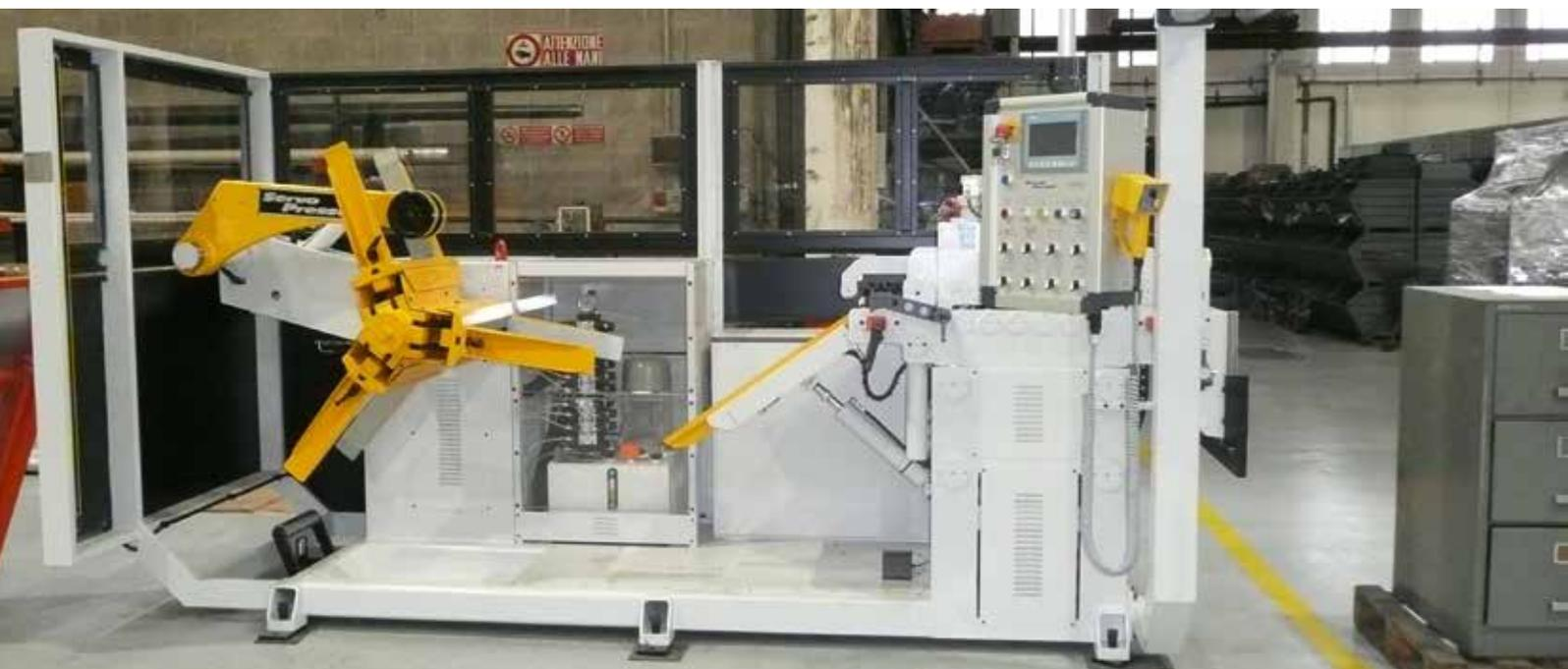
DURANTE LA PROSSIMA **LAMIERA** PRESSO LO **STAND C08 HALL 13** **SERVOPRESSE** PROPONE IL SUO “UN CAVALLO DI BATTAGLIA “ LA LINEA COMPATTA **MODELLO SMTCP 400 AE T4** CHE HA UNA LARGHEZZA MASSIMA DI 400 MM E PORTATA DI 4.000 KG. LA RADDRIZZATRICE/ALIMENTATRICE LAVORA COIL CON UNA RANGE DI SPESSORI CHE VA DA 0,6 MM A 6 MM.
