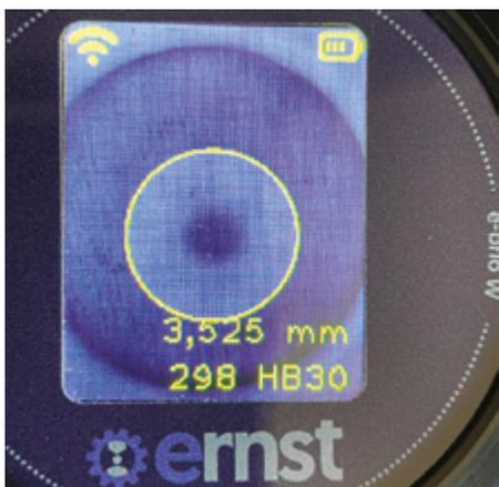
*Ernst e-brio W* permette di ottenere in modo rapido il *numero Brinell*, senza errori di interpretazione da parte dell'operatore. La lettura avviene infatti in pochi secondi con una risoluzione di 0.001 mm. Inoltre, l'immagine ingrandita dell'impronta permette di rilevare eventuali difetti della finitura superficiale. Corredato di una moltitudine di scale *e-brio-W* consente la massima versatilità nel campo della lettura di
