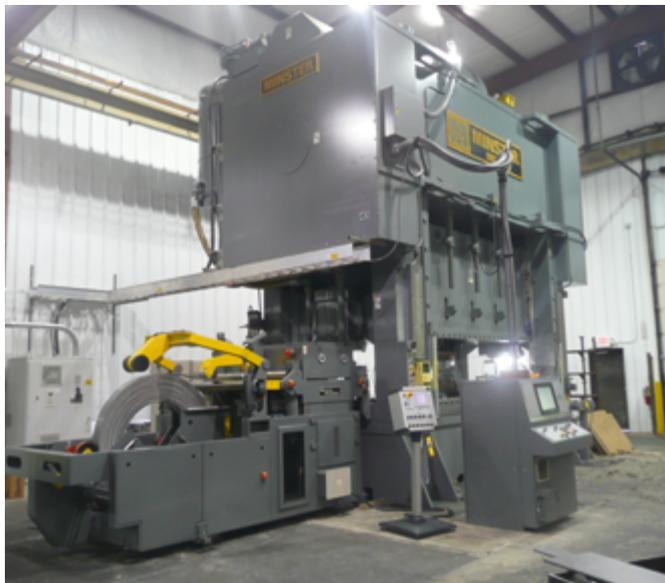
Le raddrizzatrici a culla offrono un elevato livello di sicurezza e semplicità nella gestione di coils di grosso spessore, e sono per questo molto apprezzate nel settore della tranciatura fine. Servopresse da molti anni offre questo tipo di linea di alimentazione nelle più svariate combinazioni: solo raddrizzatrice, raddrizzatrice alimentatrice con cassone singolo o doppio.
