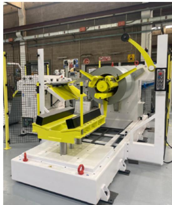
Lo **svolgitoro motorizzato con sella di carico** sono costruiti su un unico basamento per ottenere un perfetto allineamento e per agevolare la fase di carico che avviene dal pulpito di comando senza che l'operatore entri in contatto con il materiale. Tutta la motorizzazione viene coordinata in fase automatica da un sensore ad ultrasuoni che rileva le variazioni di posizione del materiale nel loop.
